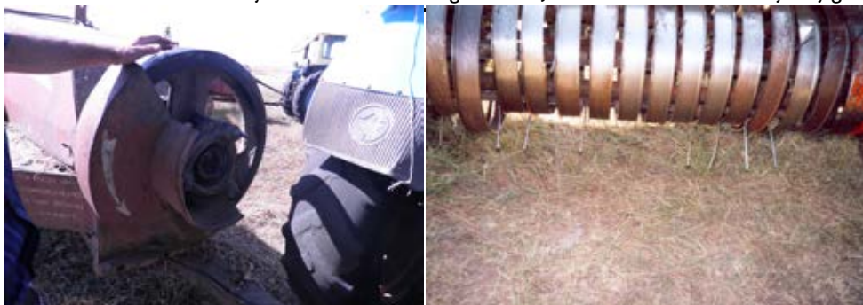
Рисунок 1. Фрагменты характерных отказов пресс-подборщика ПС-1,6 при работе на сенокосах, засоренных камнями.
