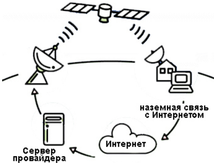
Рис. 2. Схема подключения к Интернету при связи с геостационарным спутником
