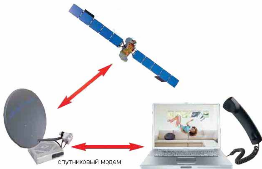
Рис. 3. Схема подключения к Интернету при связи со спутником на низкой орбите
