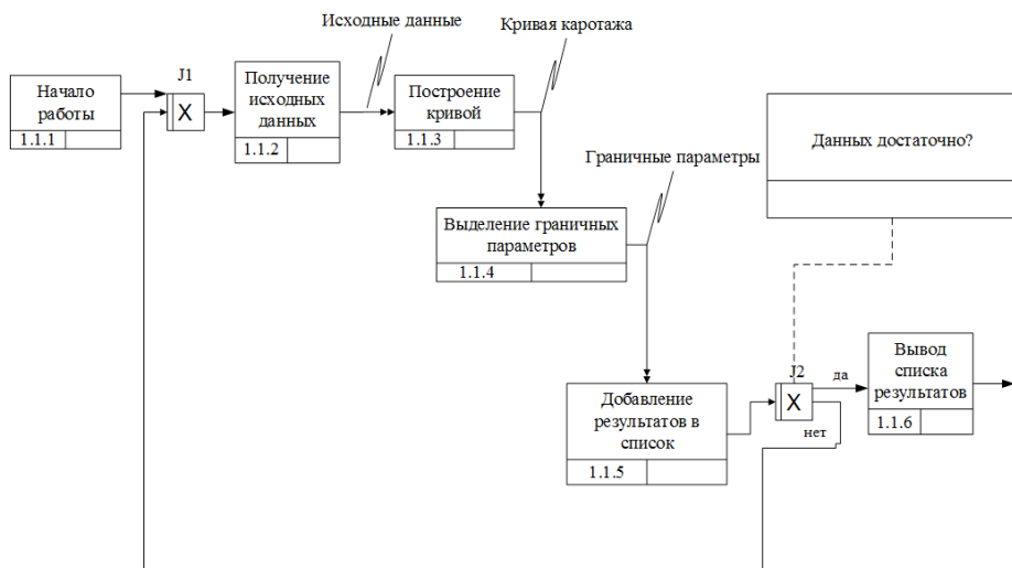
Рисунок 3 – IDEF3 – диаграмма детализации блока A41
