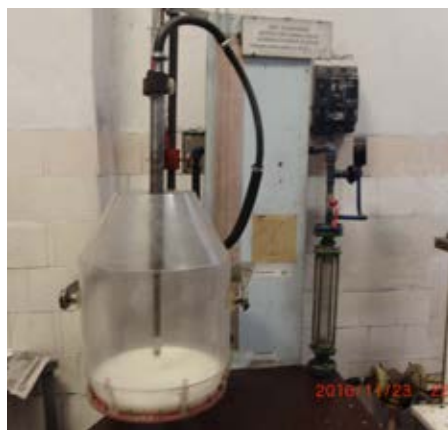
Рисунок 1 – Внешний вид лабораторной установки для исследования процесса ошлаковывания стен конвертера газа на одно сопло).
